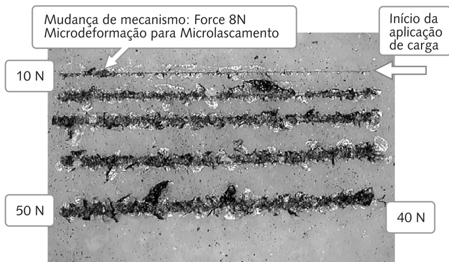
Figura 15 – Imagem do risco produzido pelo indentador com aplicação de carga de até 50 N
