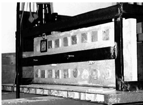
Figura 9 – Substrato fixado ao suporte, com caixilho metálico posicionado na cerâmica de teste
