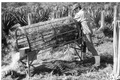
Figura 1 – Peneira rotativa para separação da bucha verde de sisal (SILVA; BELTRÃO, 1999)
