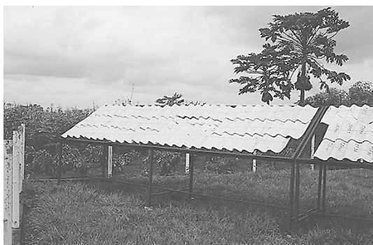
Figura 9 – Bancada de envelhecimento natural no Campus da USP de Pirassununga, SP
