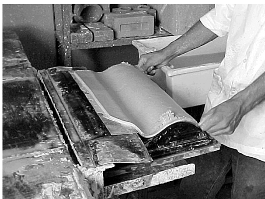
Figura 7 – Transferência da telha para molde de formato ondulado
